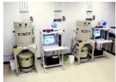
■ 食品・環境放射能測定装置 (ゲルマニウム半導体検出器)
