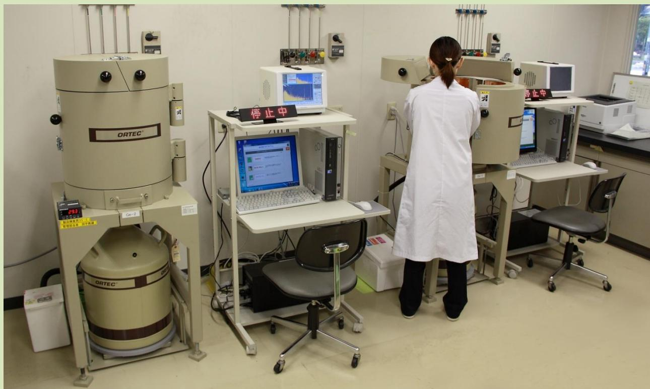
当研究所では、2台体制で放射性物質の測定を行っております。多検体でも迅速に結果を提供することができます。また、1台は高相対効率(40%以上)を有しているため、低濃度の放射性物質も短時間で測定することが可能です。
